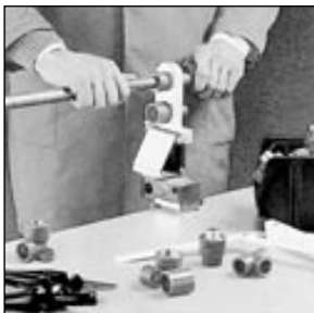
Трубы и фасонные части разогреваются (температура нагревательных элементов сварочного аппарата 260^{\circ}\text{C} \pm 10^{\circ}\text{C} )
