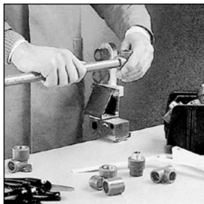
Трубы и фасонные части соединяются, образуя неразъемное соединение. Не вращая, выждать время, необходимое для остывания.
